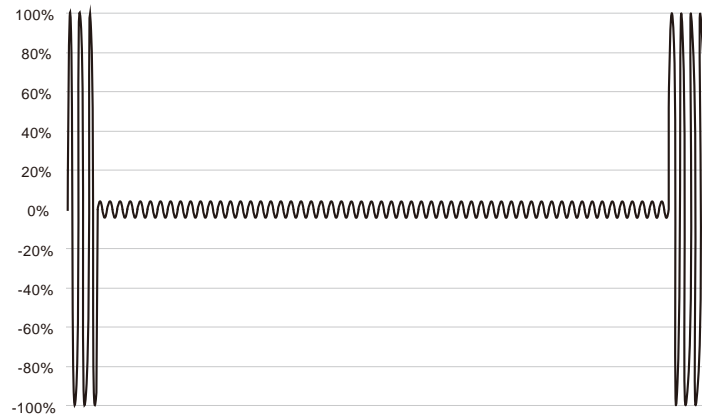
电源短时中断线压 (消失时间) 不得超出1分钟
