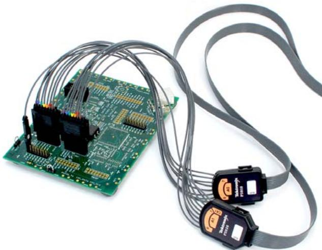
17通道P5910探头提供了灵活的通用探测功能，支持0.100英寸和2mm引脚间隔、低输入电容和附件，可以连到许多行业标准连接装置上。
