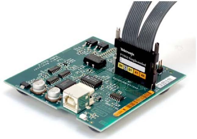
对电路板空间有限的应用，34通道高密度P5960 D-Max实现了最小的体积，提供了快速连接机制。
