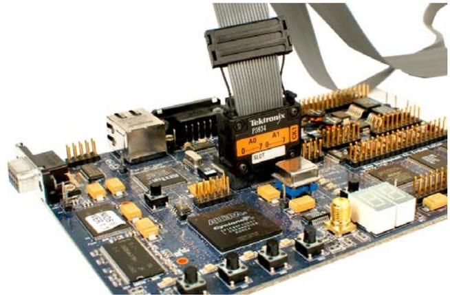
P5934是一种34通道Mictor探头，拥有快速连接/断开和正向锁存机制，保证连接牢固可靠。
