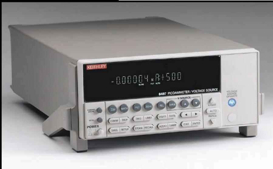
5位半6487皮安表/电压源提高了备受赞誉6485的测量能力,并增加了500V的高分辨率源。它具有比6485更高的准确度和更快的上升时间,以及配合容性元件使用的阻尼功能。这款经济有效的仪器具有8个电流测量量程和高速自动量程功能,可以测量20fA-20mA的电流,其测量速度达到1000读数/秒,并且输出200 $\mu$ V-505V的电压。
