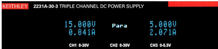
对两个30V通道进行串联或并联, 可以使输出电源翻倍, 达到60V, 或者使输出电流翻倍, 达到6A。2231A-30-3型电源具有串联和并联模式, 可以管理通道, 并显示所有输出。这个显示屏给出电源的并联模式, 包括输出电源和并联通道的整个电流。
