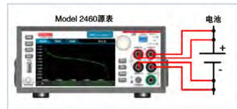
图12. 2460源表SMU仪器的图形显示器上显示的电池放电结果图
