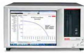
图11. 4200-SCS参数分析仪测量太阳能电池的前向偏置 I-V 特点
