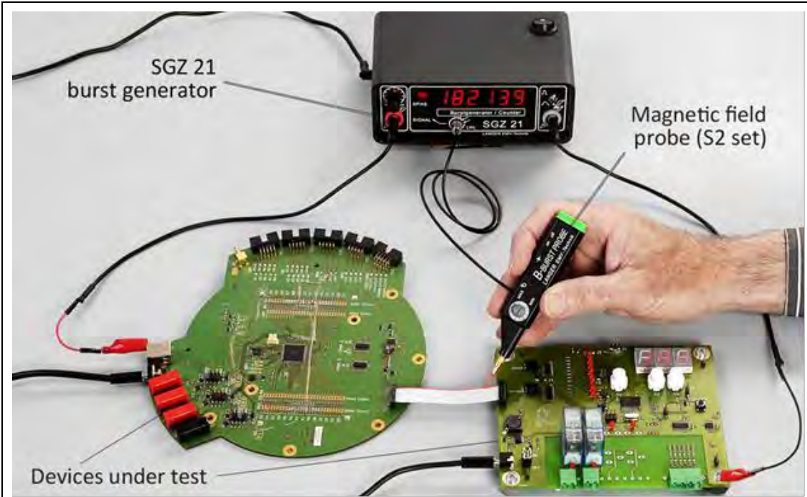
图 48：用 S2 中探头来测量带状电缆的各个内核的干扰电流。
