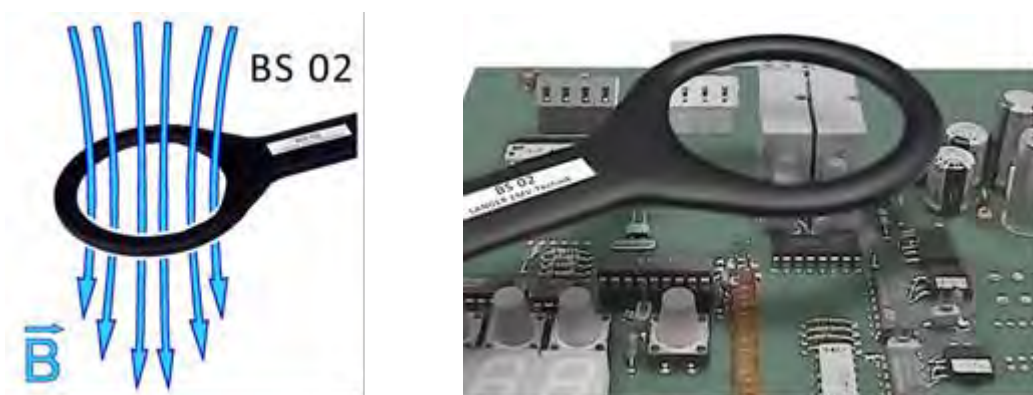
图 36：具有大场光束的 BS 02 场源应用磁场至周围 10 厘米环路的导体
