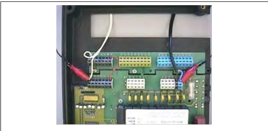
图 24: 经由一个两极连接和一个电流隔离点干扰电流注入到被测设备
