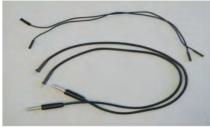
图 3：发生器电缆（底端）；两个扩展电缆（顶端）
