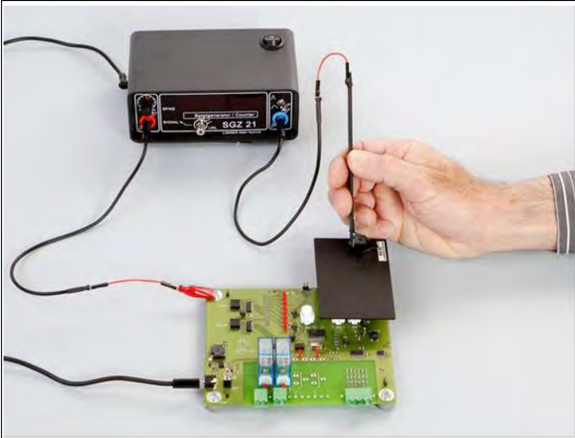
图 41：电场源逐渐朝模块移动应用电场到各条有代表性的线路。
