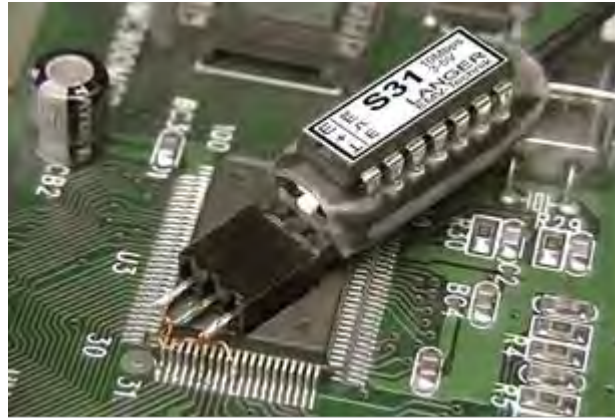
图 9：例如，在被测装置中，S31 传感器通过一个三极插座连接到集成电路中。
