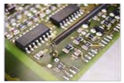
图 28：通过点朝向准备地层，焊接接触引脚，发生器电缆用微型探针连接到接触引脚，经由导体注入干扰电流到地。
