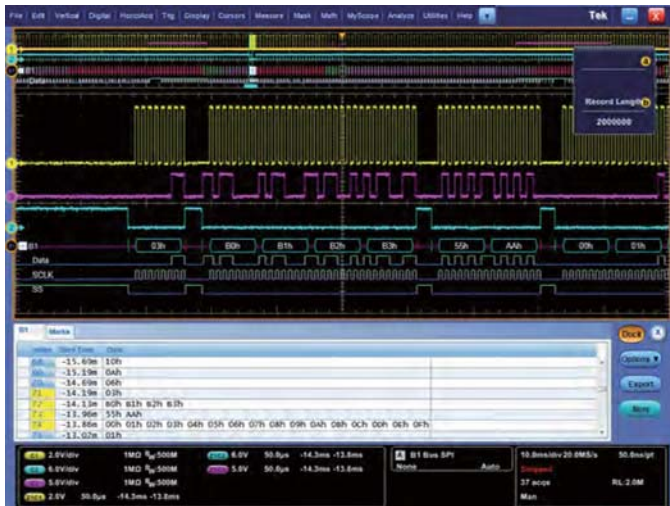
事件表显示长采集中解码后的串行数据包数据。
