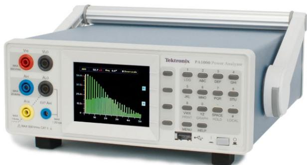
泰克 PA1000 是一种单相、单通道功率分析解决方案，经过优化用于根据国际标准进行快速、高效和准确的功耗分析。凭借其紧凑的外观、类似于 DMM 的用户界面，图形显示和强大的软件，用户可以快速可视化、分析和记录下一代设备的功耗效率，包括备用电源测量和谐波分析。
