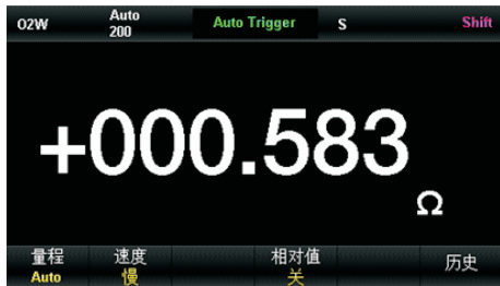
图 3-3 测试线短路读数
