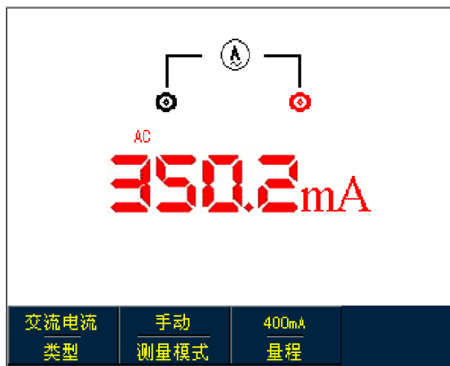
图5-19 测量40mA-400mA的交流流电流
