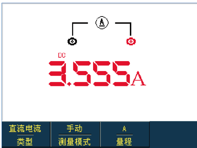
图5-9 大于400mA直流电流测量
