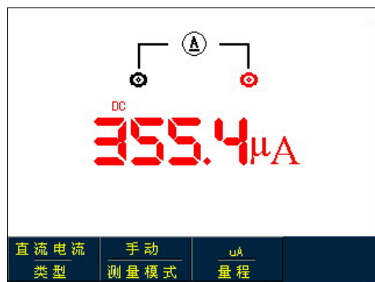
图5-13 小于等于1mA直流电流测量
