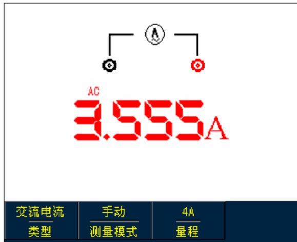
图5-20大于400mA交流电流测量
