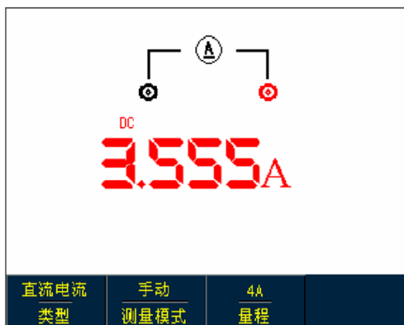
图5-16 大于400mA直流电流测量
