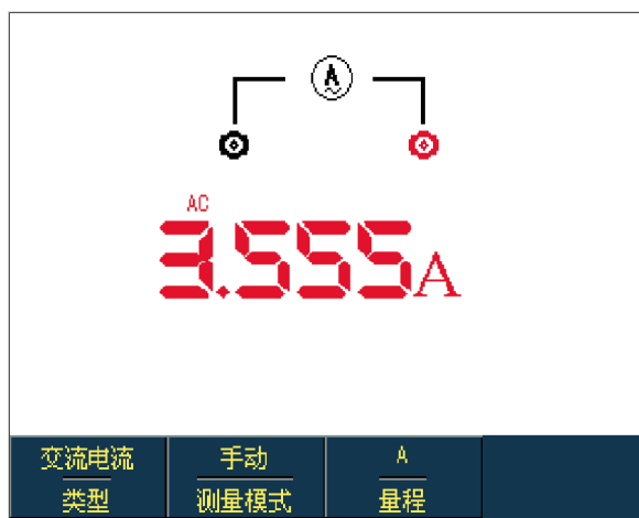
图 5-12 大于 400mA 交流电流测量
