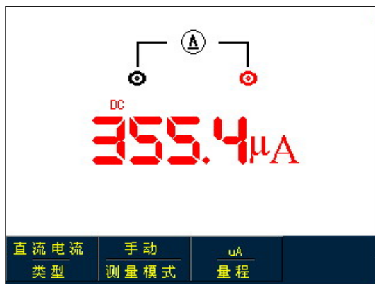
图 5-7 小于 4mA 直流电流测量
