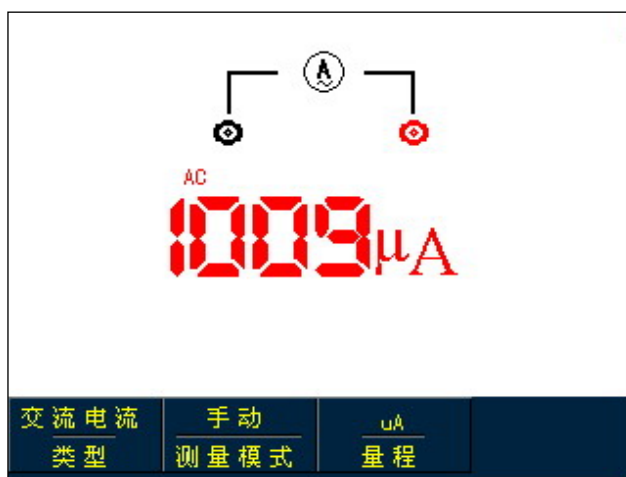
图 5-10 小于 4mA 交流电流测量
