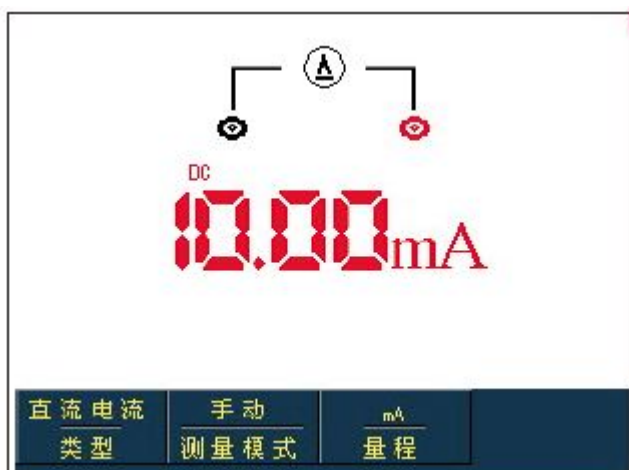
图5-8 小于400mA直流电流测量
