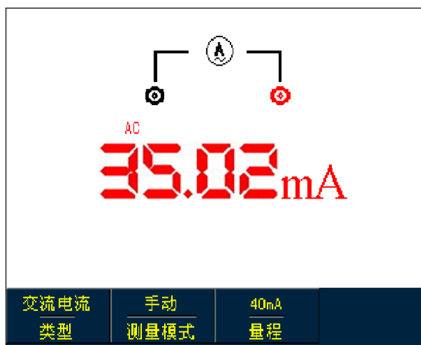
图5-18 小于40mA交流电流测量
