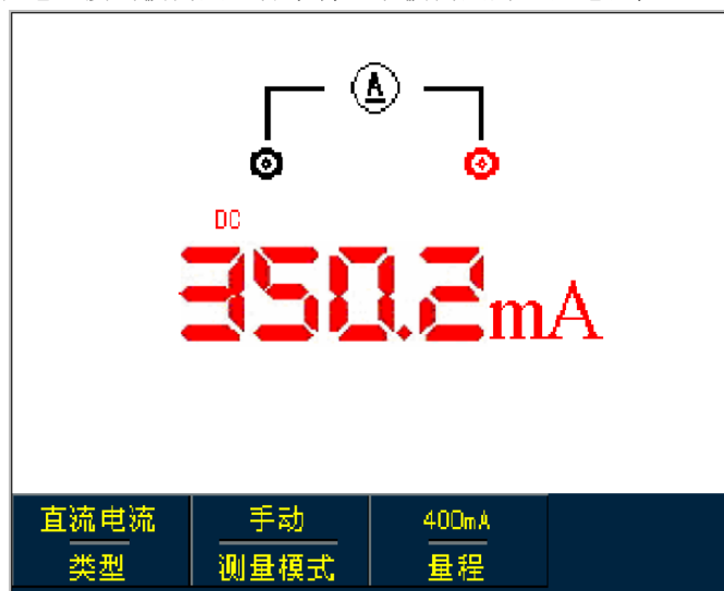
图5-15 测量40mA~400mA的直流电流
