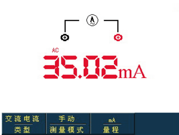
图 5-11 小于 400mA 交流电流测量
