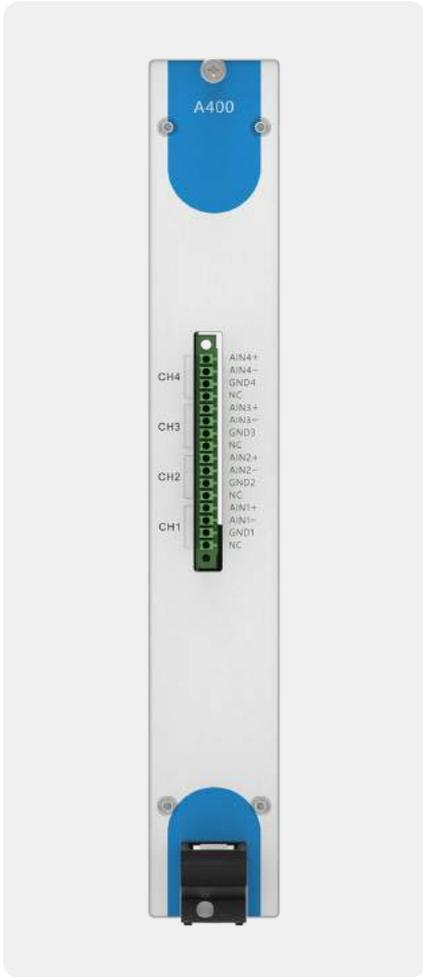
A400数据采集卡，是一款普赛斯自主设计开发的插卡式，支持可变速率采样和大容量数据存储的高精度数据采集卡。
