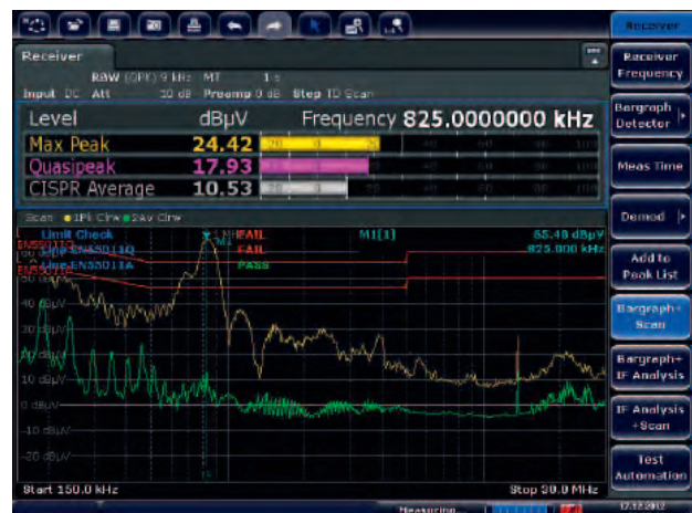
R&S®ESRP通过准峰值和平均加权, 在短短数秒之内即可执行骚扰电压测量
