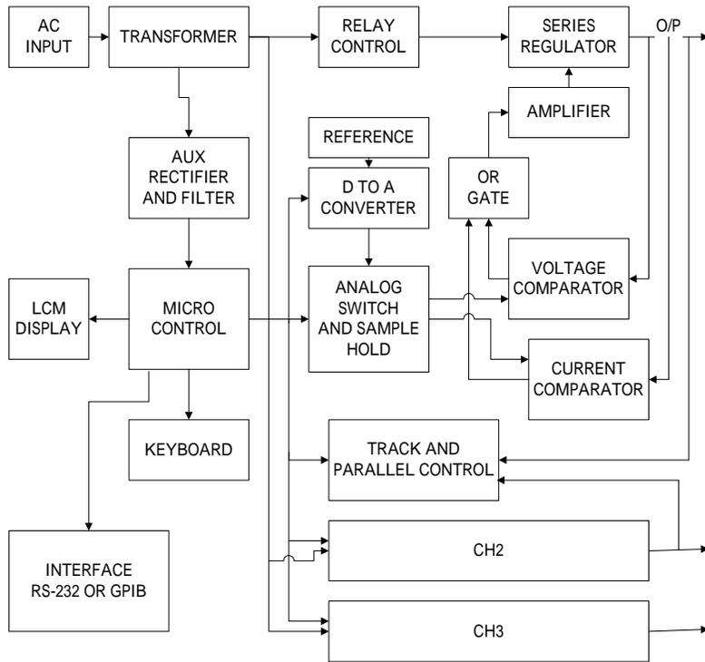
上图是 PST-SERIES 系统方块图，整体架构分别由微处理机 MPU(Micro Processor Unit)，数字/模拟转换电路 DAC(Digital to Analog Converter)，模拟电子开关电路(Analog Switch Circuit)，参考电压电路(Reference Voltage Circuit)，驱动电路(Driver Circuit)，控制电路(Control Circuit)，串联/并联电路(Track / Parallel Circuit)，比较
