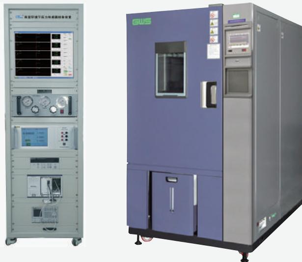
压力传感器、变送器广泛应用于航空、航天、军械、石油及化工等众多领域，其工作性能的优劣直接关系到装备成品的工可可靠性、稳定性及精准性。因此，压力传感器、变送器在具体装备上安装之前就必须要求得到其具体的特性参数，然而，要取得这些特性参数就必须要有可靠的设备来具体实施，OI-961型高低温压力传感器、变送器计量系统为这项工作提供了可靠的保障。
