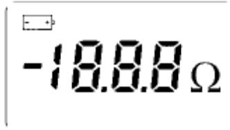
该 LCD 包括数字显示测量值, 以及相关的单位符号。符号“minus”表示测量状态为反向。
