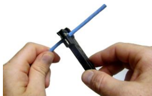
环剥线缆外护套，离线终端76mm
