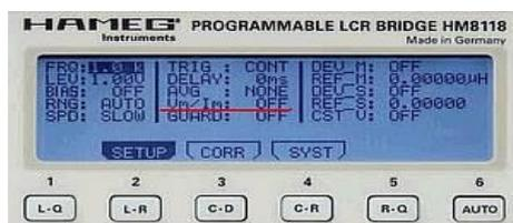
答：您可计算出数学上的电压范围及电流范围，但 HM8118 在操作期间直接读出这两个值。在设置 Menue 该操作可接通/关断。在该设置 Menue，在元件端子的电压和电流显示可接通/断开。
