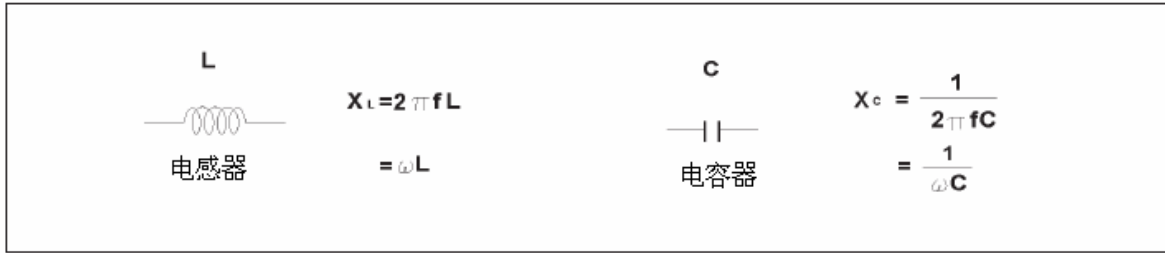
图 4. 电抗的两种表示形式---感抗 ( X_L ) 和容抗 ( X_C )
