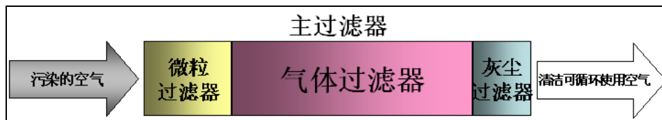
图 4 过滤器吸附物理过程图
