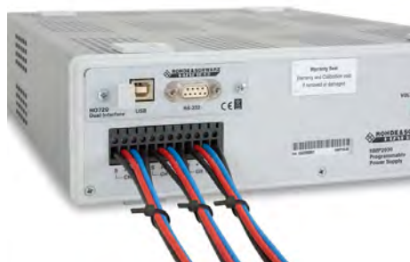
电源后面输出端子排示例
